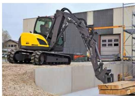
*Manutention avec fourches à plus de 5 mètres de hauteur et, unique sur une pelle, en négatif jusqu'à - 2,20 mètres*
