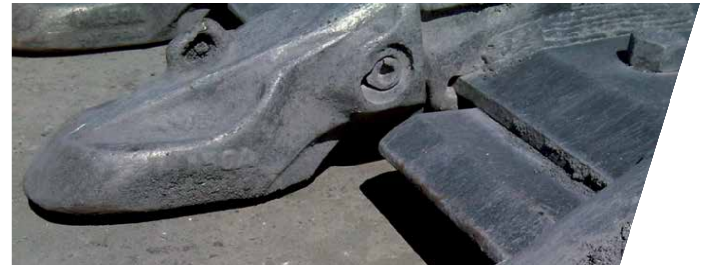
G.E.T. lors d'applications avec des scories chaudes en Espagne.
