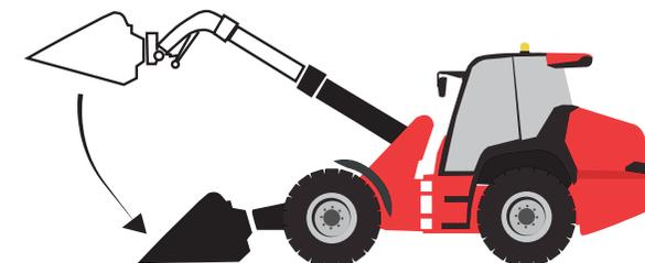
3 - **Retour automatique à la charge** : pour revenir facilement à une position (accessoire et flèche) pré-établie par l'opérateur. Cette fonction est particulièrement intéressante pour des opérations de chargement.
